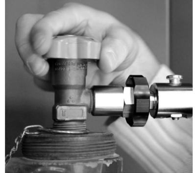
6) Ouvrir progressivement la vanne d'arrêt de la bouteille
