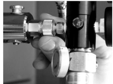
5) Ouvrir progressivement la vanne d'arrêt du cylindre d'hélium
