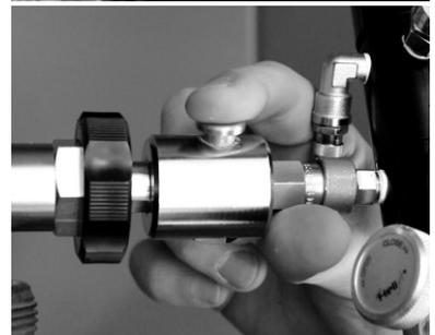
10) Déconnecter le raccord rapide HP de la bouteille, réinsérer la bouteille dans son carter de protection.
